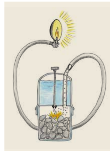
Il funzionamento della lampada a carburatore. (Disegno G. Terranova)
